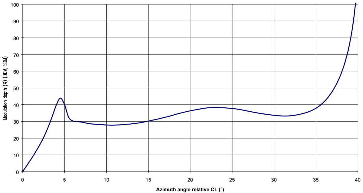
**Figure 5-15 DDM modulation distribution**
